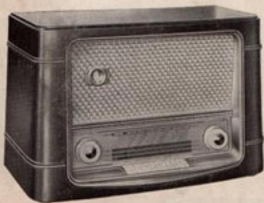
**FM 33** - Classe Anie - Radioricevitore 6 valvole più occhio magico - Onde medie - 2 gamme onde corte - Modulazione di frequenza - TASTIERA DI COMMUTAZIONE - Altoparlante magnetodinamico - Antenna incorporata per FM - Mobile in plastica finemente rifinito
