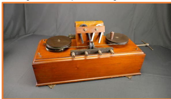
Fotografia N° 7 detector Magnetico Marconi
