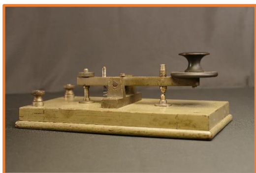
Fotografia N°5 Tasto del tipo verticale
