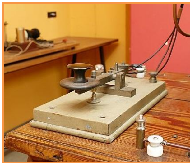
Tasto telegrafico del tipo molto pesante
