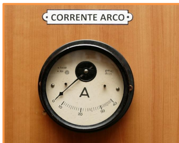
L'amperometro per misurare la corrente arco
