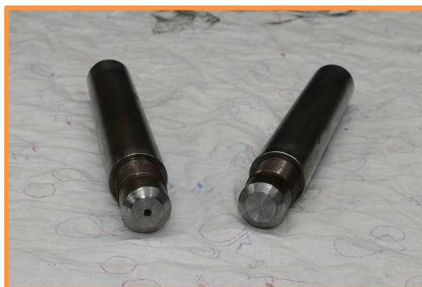
Les masses polaires après l'usinage
