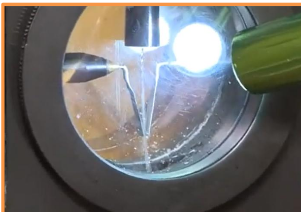
Positionnement des plaques par rapport à la veine liquide et positionnement de la buse
