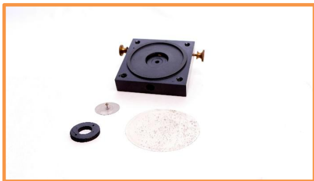
Membrane de platine à gauche et membrane de mica à droite
