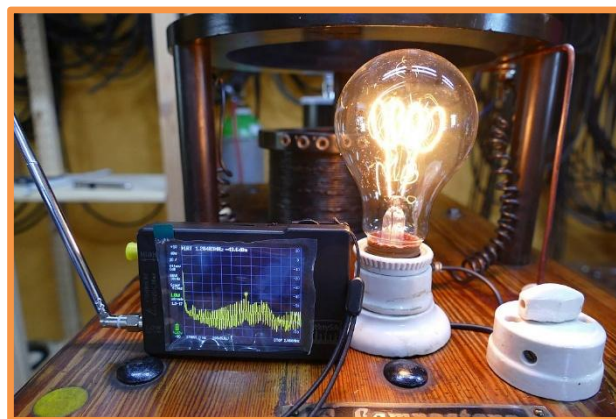
Le système commence à osciller à 1.200 kHz, l'ampoule I1 avec fonction de charge fictive s'allume intensément
