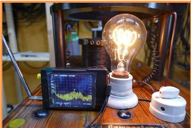
Ampoule de charge fictive I1 et analyseur de spectre
