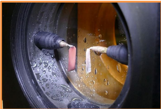
Les plaques B et C (probablement en platine) sont connectées à la source de courant continu
