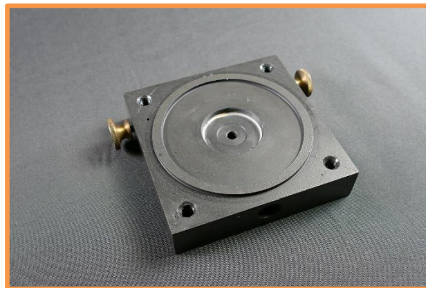
Sede della lamina di platino con applicazione di mastice sigillante
