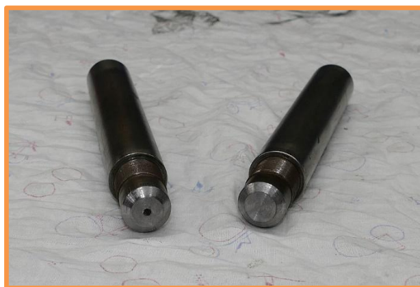
Le masse polari dopo l'operazione di tornitura
