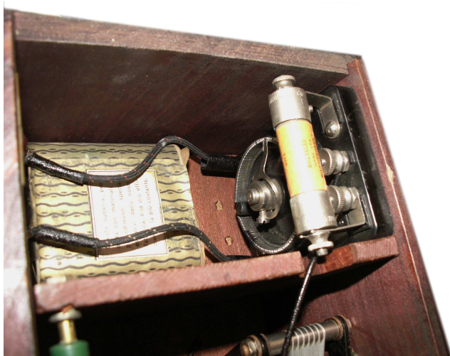
Detector a Carborundum montato su di una "galena" degli anni '20.
