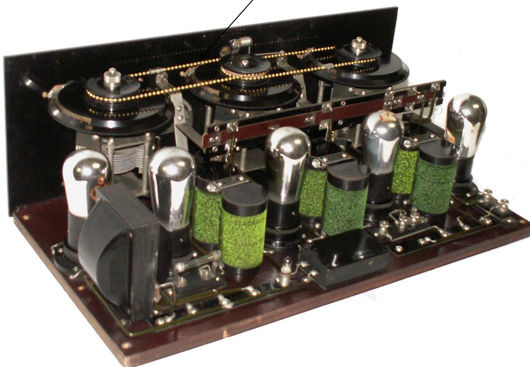
Sistema di collegamento dei condensatori variabili
