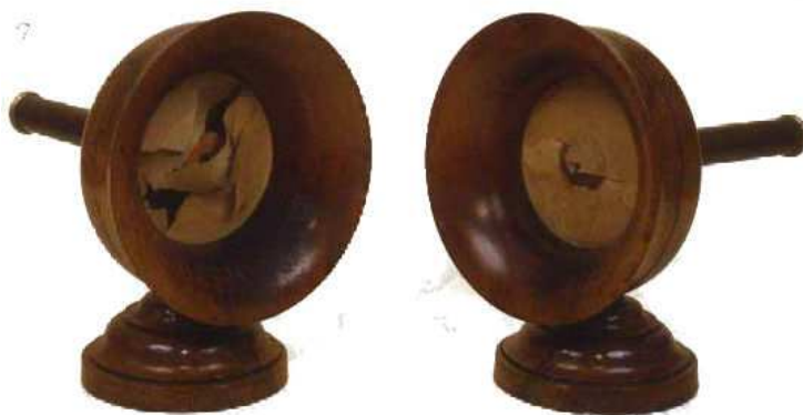
Coppia di ricevitori telefonici a grande membrana A. Righi 1878
