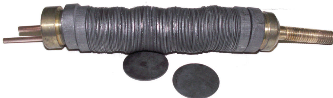
Colonna di dischetti di grafite con le terminazioni in ottone
