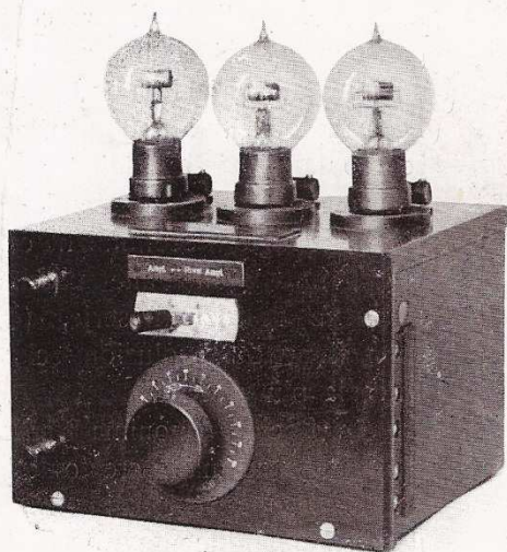
Amplificatore a bassa frequenza a 3 gradi di amplificazione.
