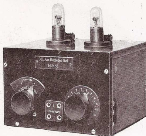
Amplificatore a bassa frequenza a due gradi di amplificazione.
