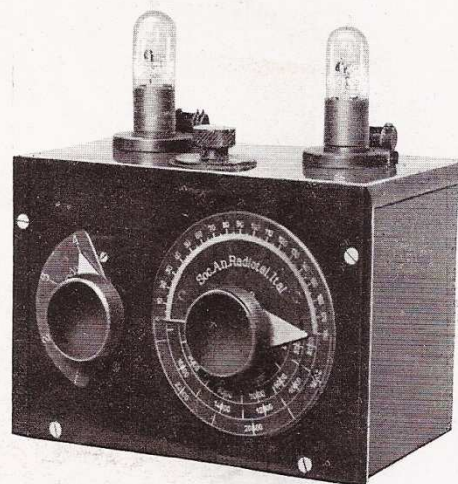
Generatore eterodine per lunghezza d'onda da 400 fino a 24.000 m.
