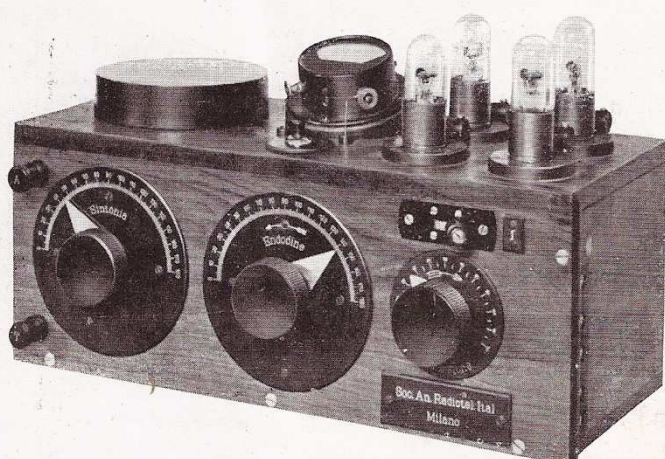
Apparecchio ricevente universale per lunghezza d'onda da 500, fino a 20.000 m.
