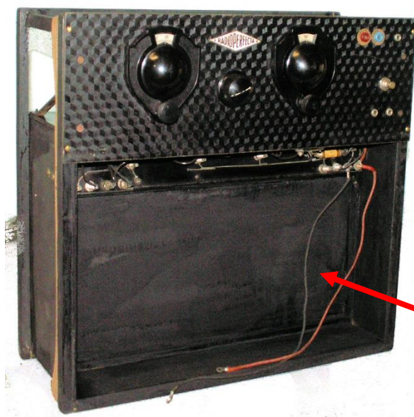
cavi di collegamento tra il telaio e l'altoparlante
