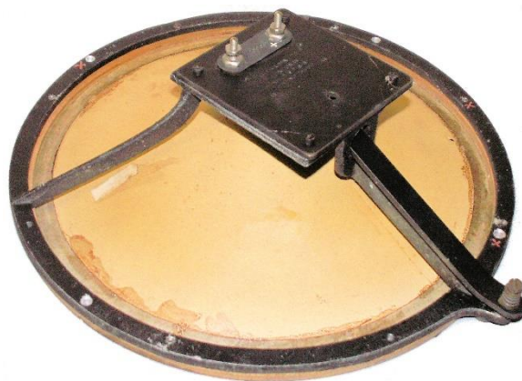
cavi di collegamento tra il telaio e l'altoparlante
