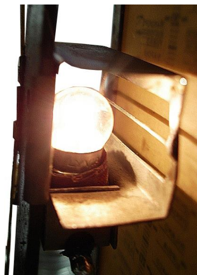
Sistema di illuminazione della scala numerica
