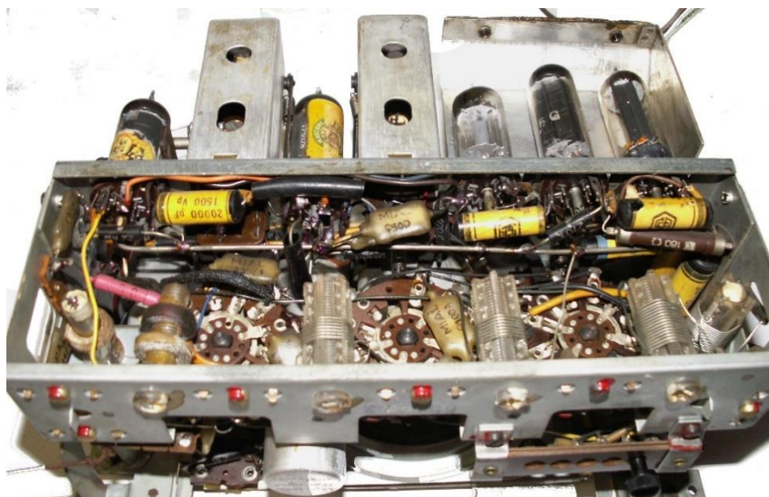
Vista della parte inferiore dell'apparecchio con il telaio reinserito sul mobile, altra particolarità di questo modello è che il mobile si "calza" sul telaio dall'alto.
