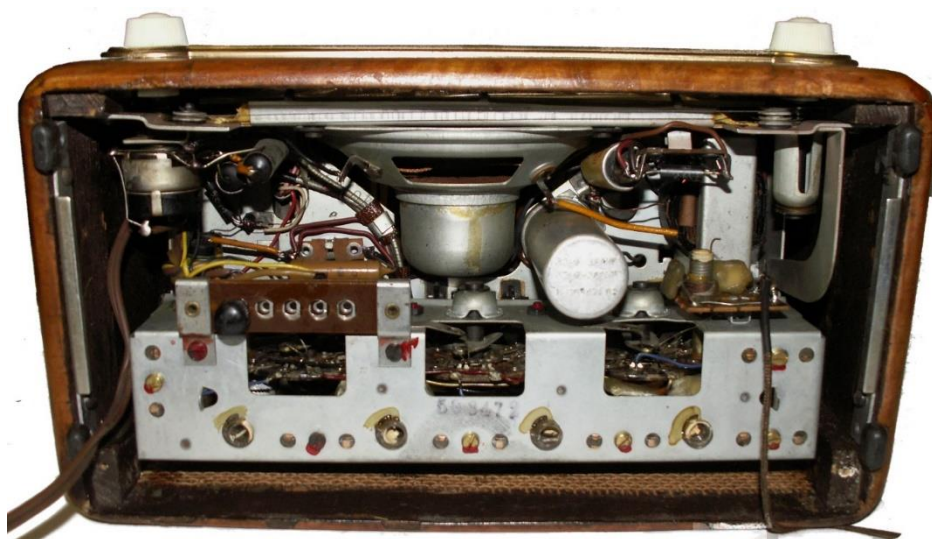
Vista della parte inferiore dell'apparecchio con il telaio reinserito sul mobile, altra particolarità di questo modello è che il mobile si "calza" sul telaio dall'alto.
