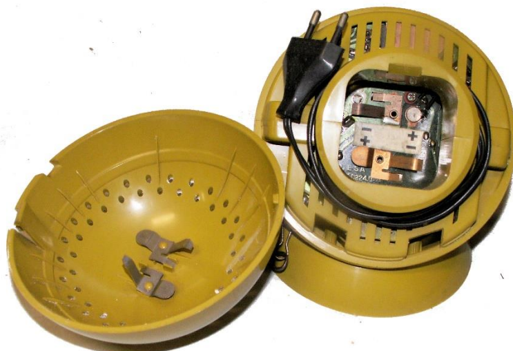
Lato posteriore con la sede delle batterie e del cavo di alimentazione.
