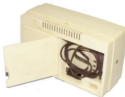
Vano porta cavo di alimentazione
