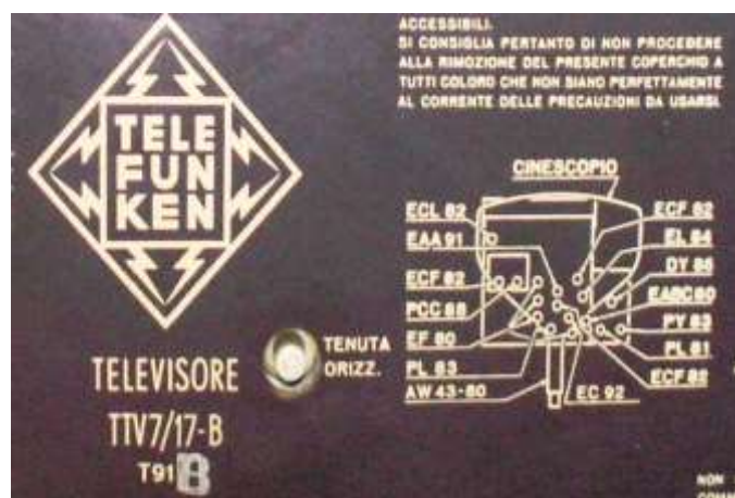
Targhetta identificativa con posizione delle 14 valvole
