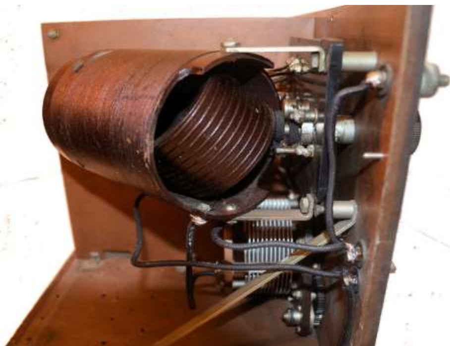
Pannello - bobina con variometro e condensatore variabile
