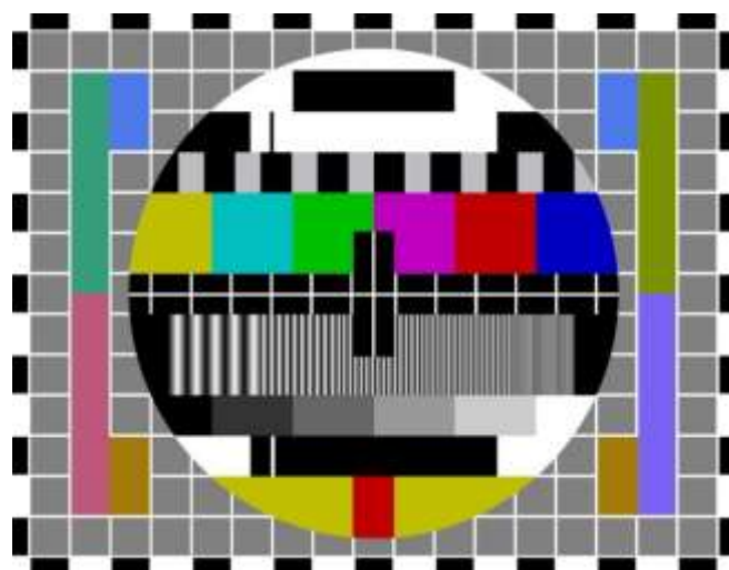
Monoscopia PHILIPS PM5544 - generato elettronicamente.
