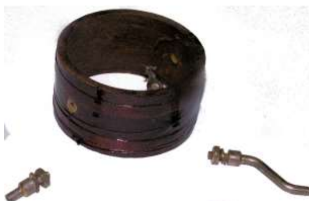
Componenti della bobina interna mobile
