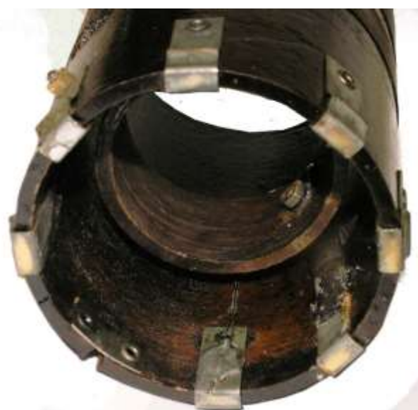
Vista con bobina mobile all'interno - variometro
