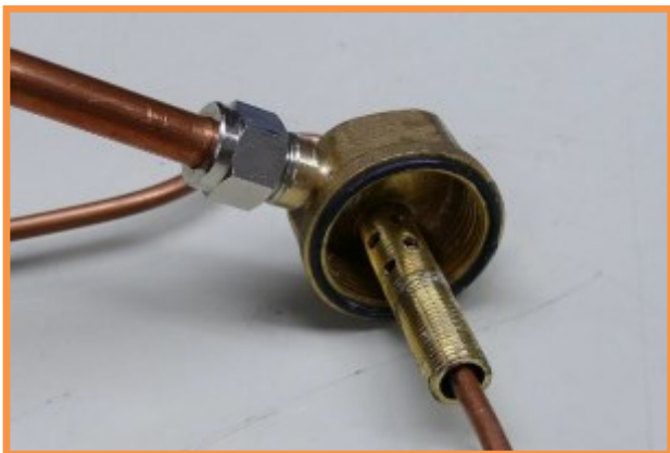
Sistema per introdurre gas nel tubo più grosso e contemporaneamente alcool tramite il tubicino
