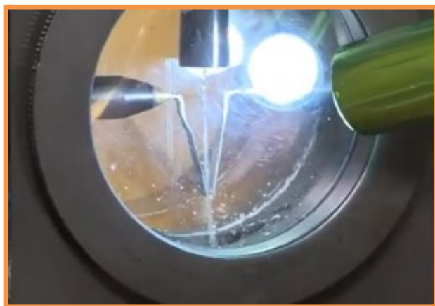
Posizionamento delle lamelle in rapporto alla vena liquida e posizionamento dell'ugello
