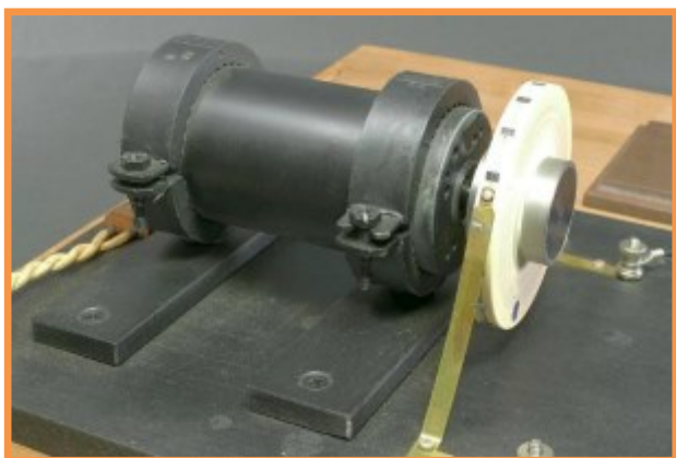
Il misterioso motorino elettrico "TIKKER", si nota la ruota dentata e il contatto strisciante
