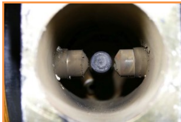
La camera dell'arco in primo piano le masse polari e al centro il catodo di carbone
