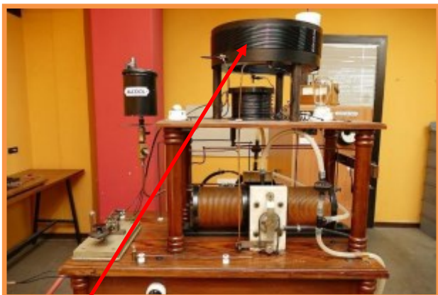
Bobina L4 infilata sopra la bobina L3
