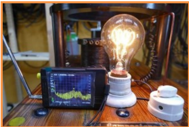
Lampadina carico fittizio I1 e analizzatore di spettro
