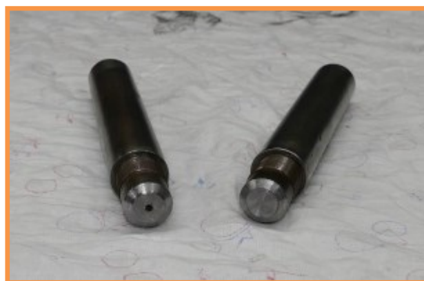
Le masse polari dopo l'operazione di tornitura
