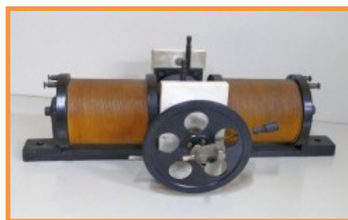
Grossa ruota usata per variare la posizione dell'anodo rispetto alla posizione del catodo
