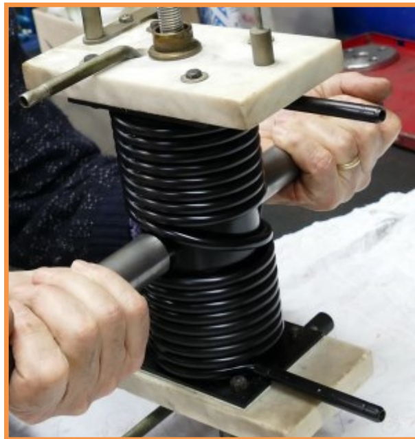
Il tubo di rame avvolto strettamente sulla camera dell'arco
