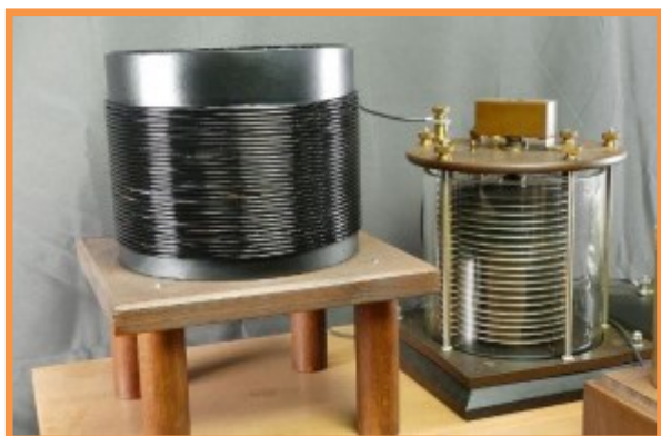
Il circuito d'antenna induttanza capacità in parallelo
