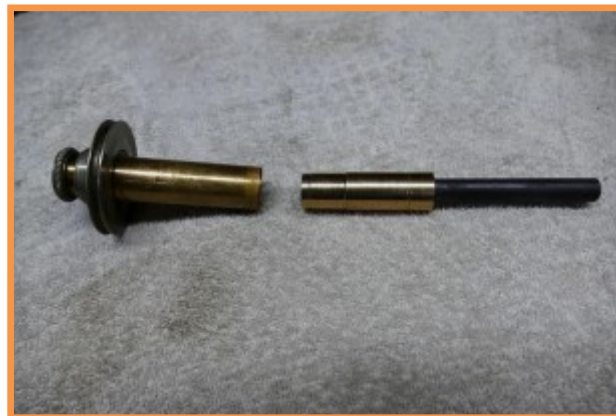
Catodo di carbone di diametro ridotto
