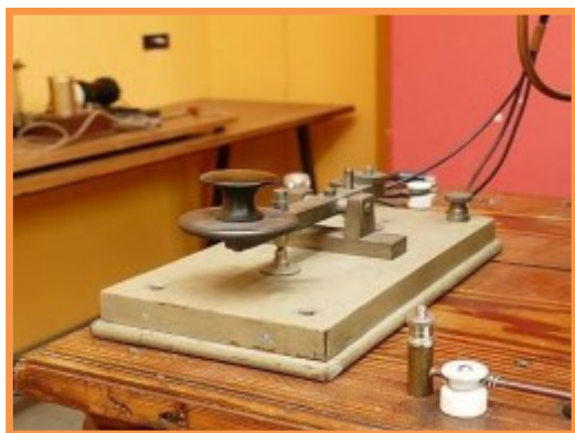
Tasto telegrafico del tipo molto pesante
