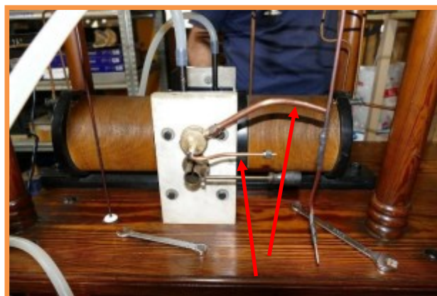
Il sistema rimontato sulla camera dell'arco, in alto il tubo per riempire di gas la camera, in basso il tubicino dell'alcool
