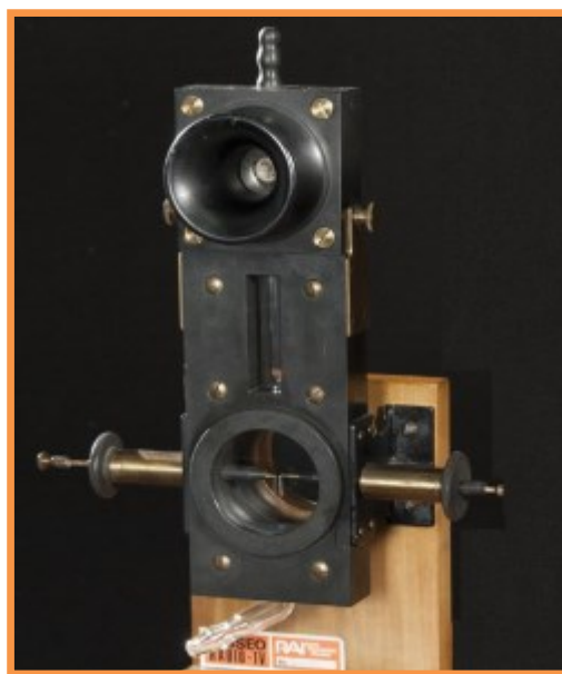
Microfono a vena liquida (microfono ad acqua)
